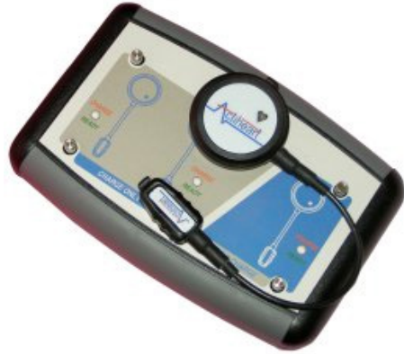
装有一个监测仪的数据读取装置/充电器
