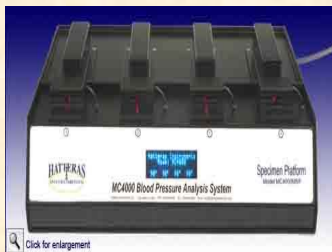
Hatteras Instruments (USA) 精确的计算机监控下尾套法 测定血压(小鼠或大鼠)
